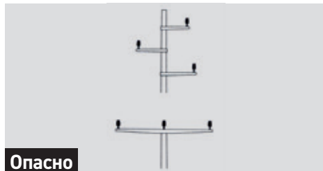
Слика 8. Потпорните изолатори се многу опасни (лево). Ваквите изолатори се неутрализираат со поставување капи (десно и насловна фотографија).
